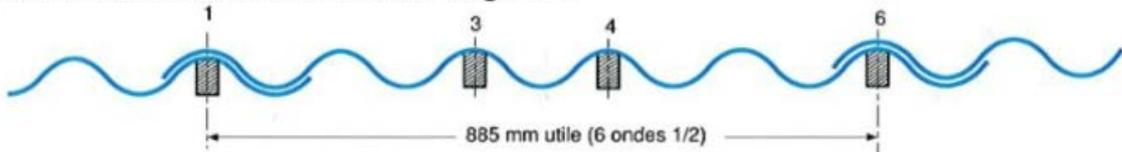
Figure 4 : Recouvrement longitudinal des plaques RENOLIT Ondex GO
