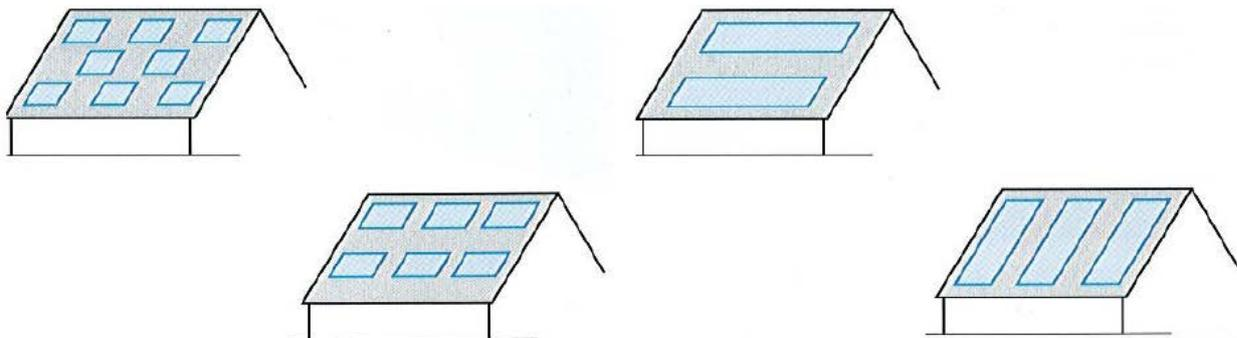
Figure 7 – L'utilisation des plaques RENOLIT Ondex en partie éclairante peut se faire en damier ou en bande continue
